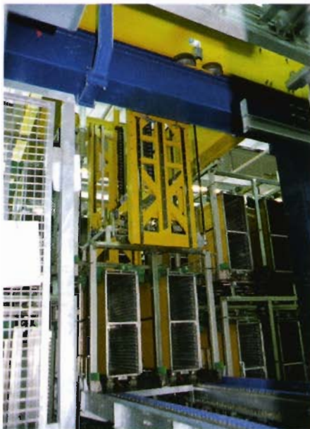
4: Stapleinrichtung des Portalroboters. Das System ermöglicht ein Speichern in zwei Ebenen übereinander
