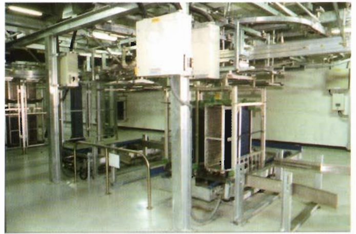
3: Übergabe zur Reinigungs- und Waschanlage. Heb- und senkbare Kettenförderer verbinden die Elektrohängebahn mit der Power & Free-Anlage
