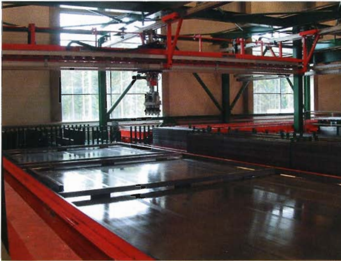
4 Automatisches Setzen der Schalungen durch den Schalungsroboter
