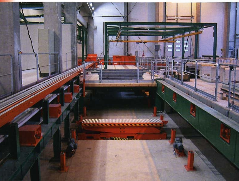
1 Produktionslogistik auf zwei Ebenen – unten Hubwagen in der Transportebene, oben Bearbeitungsebene
