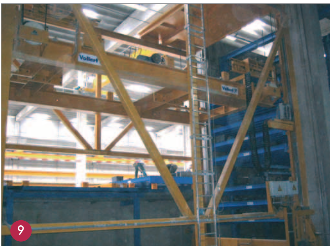
Ein-/ Auslagern der Paletten in der Härtekammer mit dem Regalbediengerät.
