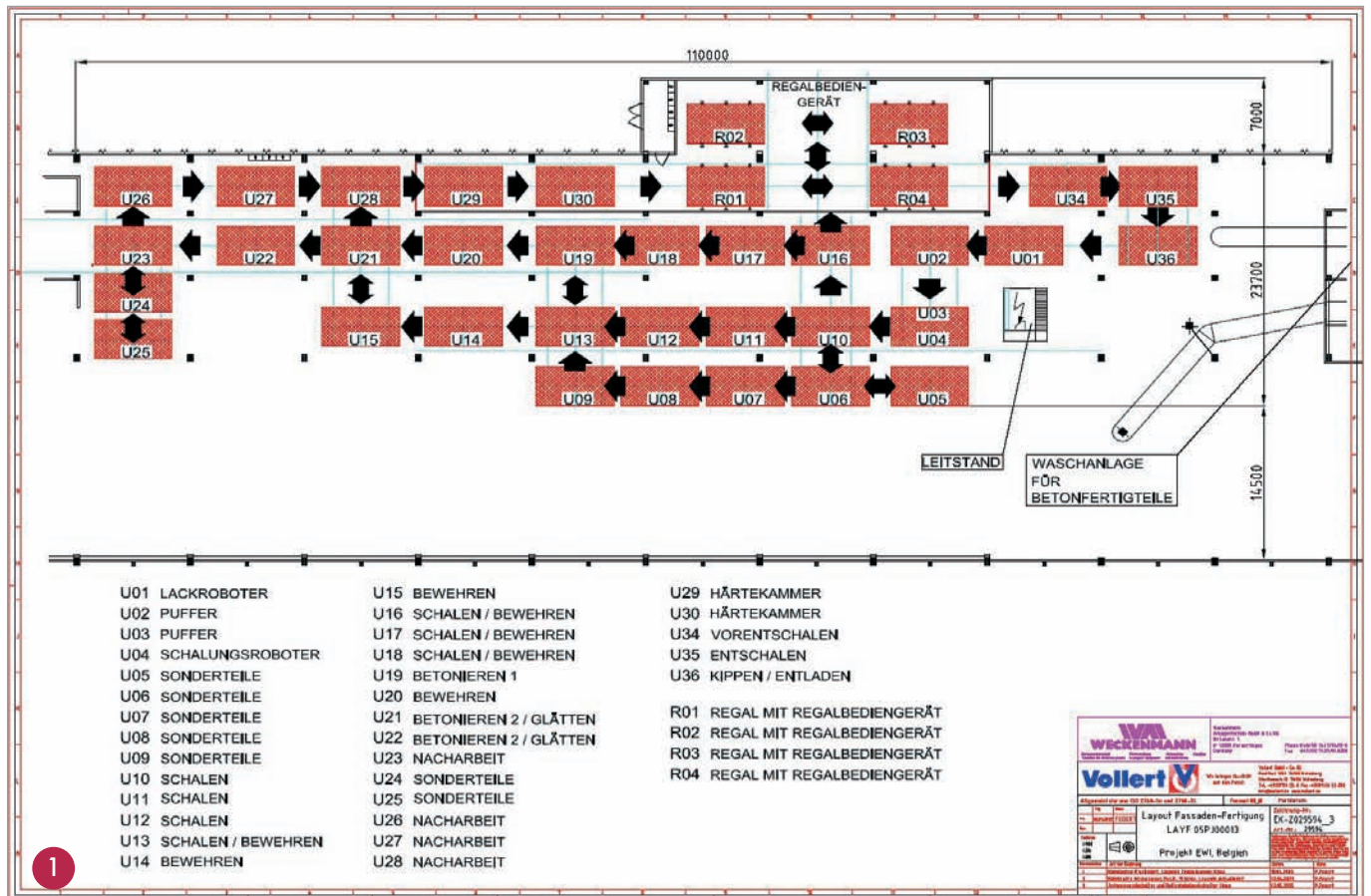
Das Layout der neuen Anlage, die bei EWI in nur vier Wochen in Betrieb genommen werden konnte
