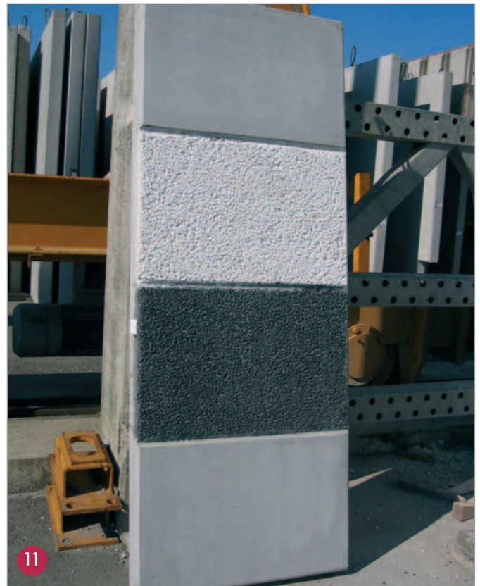
Betonfertigteile auf Lagerplatz mit verschiedenen Oberflächenstrukturen
