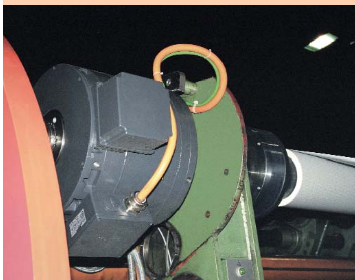
Auf jeder der beiden Wickelachsen ist jeweils auf engstem Raum ein Torquemotor der Baureihe 1FW3 eingebaut. Beide Motoren haben ein Nennmoment von 750 Nm und ein Maximalmoment von 1390 Nm
