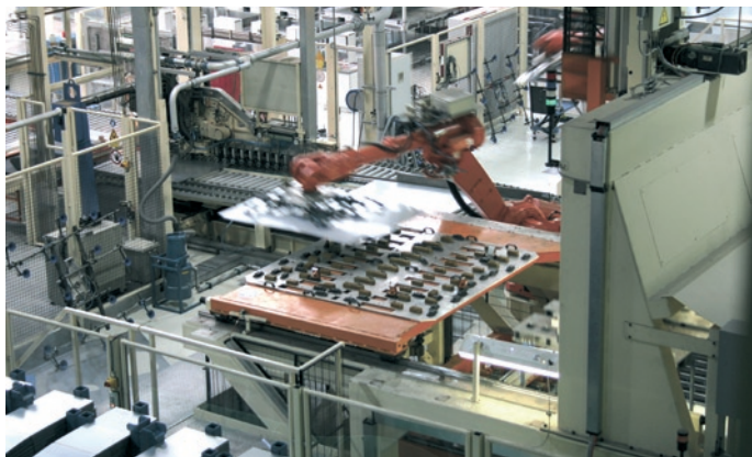
Bild 1: Roboter führen die Platinen der Laserschweißmaschine zu
