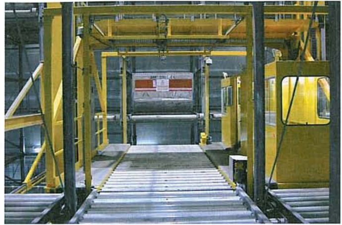
Bild 2: Lasten bis zu einem Gewicht von 14 Tonnen kann das vollautomatische Regalbediengerät bewegen
