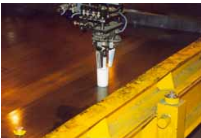
Der Insert-Roboter setzt einen Aussparungskörper
