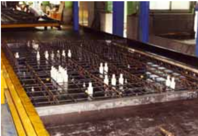
Bewehrte Palette mit Ausparungskörpern und Gewindehülsen
