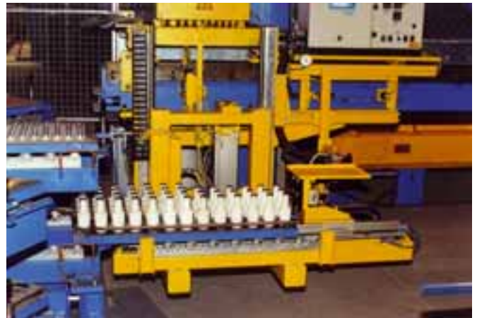
Das Shuttle sorgt für kurze Fahrwege des Insert-Roboters.
