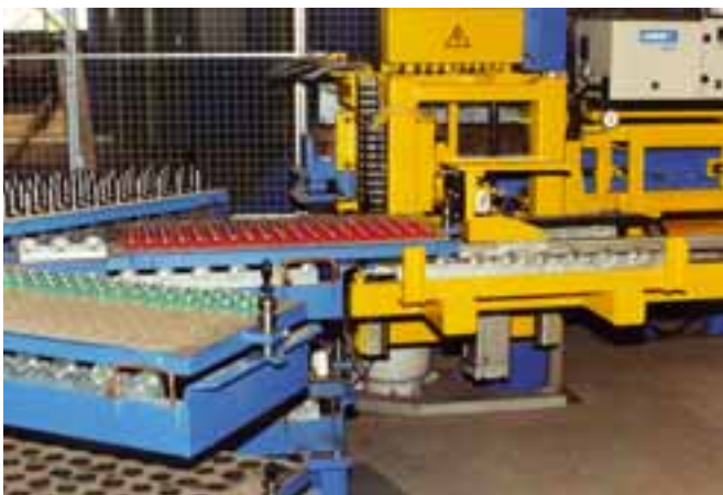
Das Shuttle holt ein Transportblech mit Gewindehülsen vom Rundtisch.
