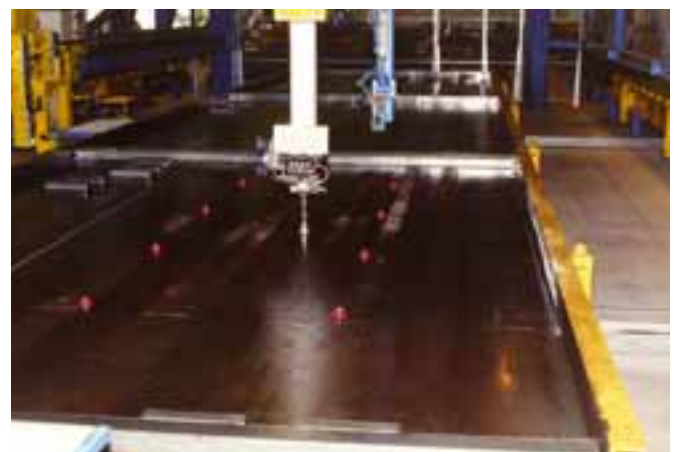
Der Insert-Roboter setzt Gewindehülsen
