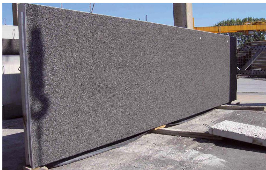
Fassadenelement mit Waschbetonoberfläche und integrierter Wärmeisolierung.
