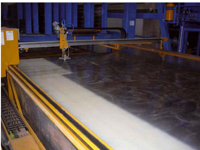
Der Lackroboter sprüht den Verzögerer auf die Palette.
