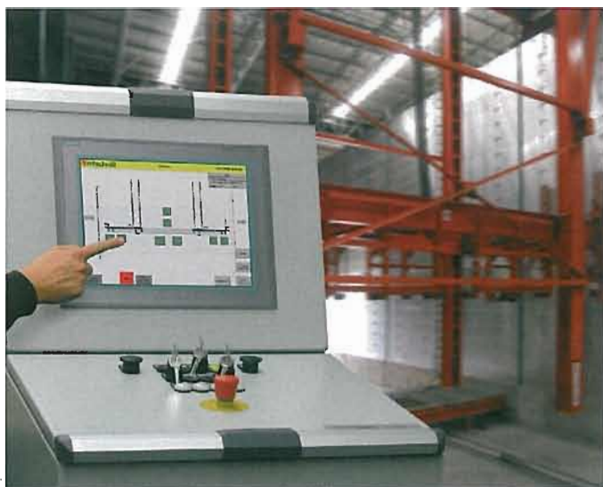
Рис. 1 Сенсорный экран для управления циркуляцией поддонов.
