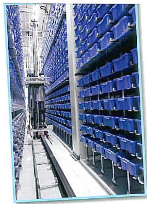
Größtes Einzelgewerk im Paket »Logistische Systeme« ist ein automatisches Kleinteilelager für Geschirr und Bestecke mit Platz für über 2500 Behälter.
