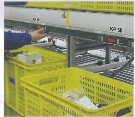
Bild 2: Die „Pick by Light“-Anzeige verrät dem Mitarbeiter in welchen Behälter er den Artikel legen soll
