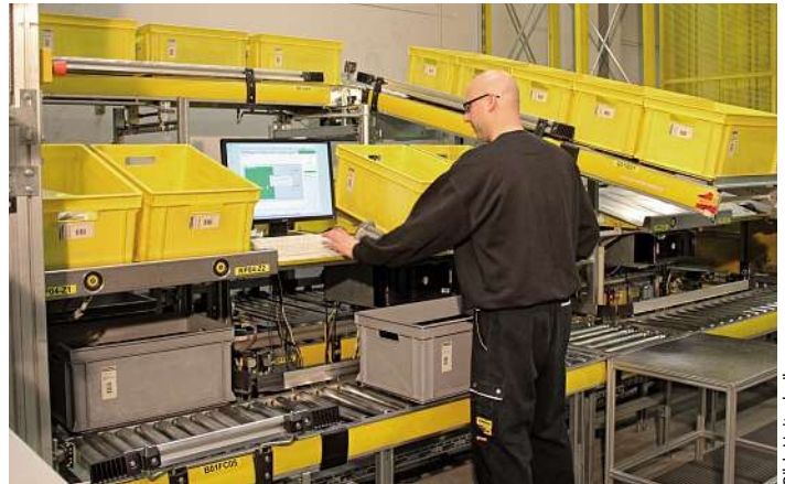
Die benötigten Artikelbehälter fahren an den Kommissionierplatz. Dort wird im Ware-zur-Person-Prinzip per Bildschirmdialog kommissioniert.
