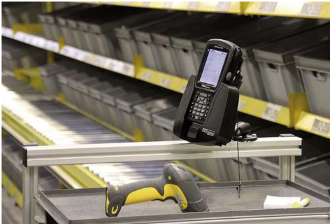
Die manuellen Lagerbereiche, aus denen der Nachschub für das Durchlaufkanalregal kommt, werden per Handheld verwaltet.
