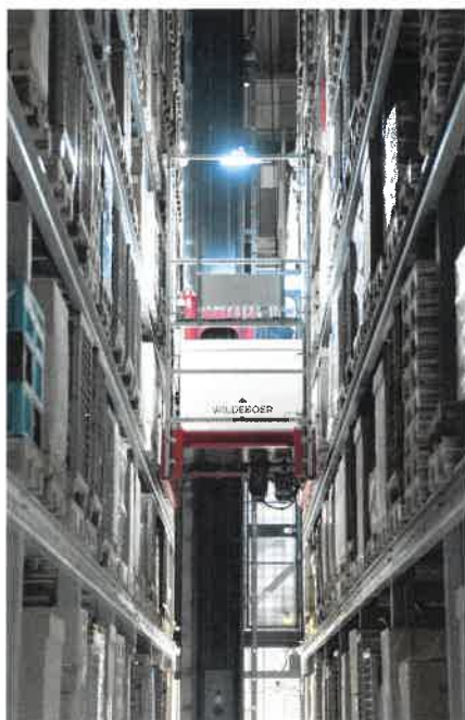
Im Logistikzentrum stehen ein dreigassiges Hochregallager für Europaletten und Gitterboxen sowie ein eingassiges automatisches Kleinteilelager für KLT-Behälter.
