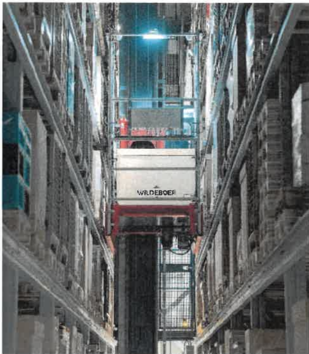
Bild 2 Im Logistikzentrum stehen ein dreigassiges Hochregallager für Europaletten und Gitterboxen sowie ein eingassiges automatisches Kleinteilelager für KLT-Behälter. Foto: Unitechnik
