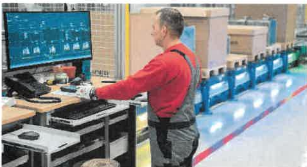
Bild 3 An kombinierten Paletten- und Behälterkommissionierplätzen wird Material sowohl für die Produktion wie auch für Kundenaufträge zusammengestellt. Foto: Unitechnik
