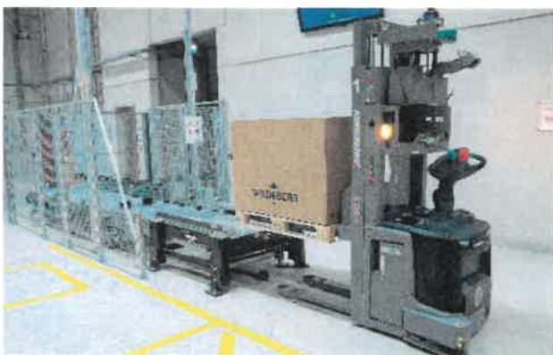
Bild 4 Die gefertigten Bauteile werden über FTS-Fahrzeuge aus der Produktion abgeholt, an die Unitechnik-Fördertechnik abgegeben und eingelagert. Foto: Unitechnik
