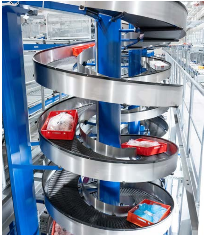
Über Spiralförderer werden die Warenträger für einen Auftrag exakt in der benötigten Sequenz an die darunterliegenden Arbeitsplätze geleitet.
