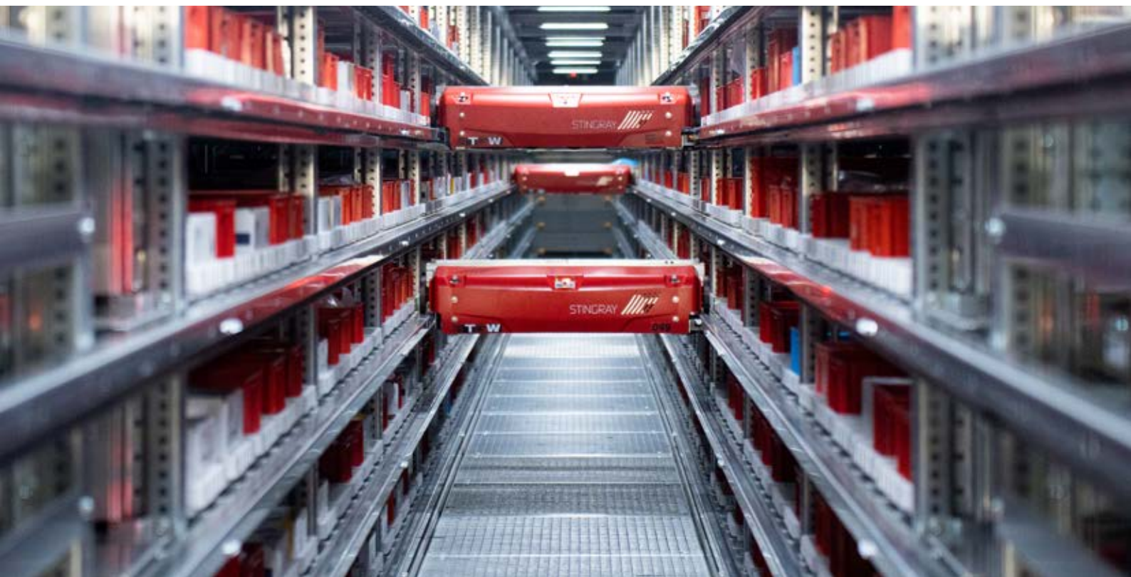
Insgesamt 104 Shuttle-Fahrzeuge sind bei Borgmeier in vier Gassen mit jeweils 26 Ebenen aktiv.
