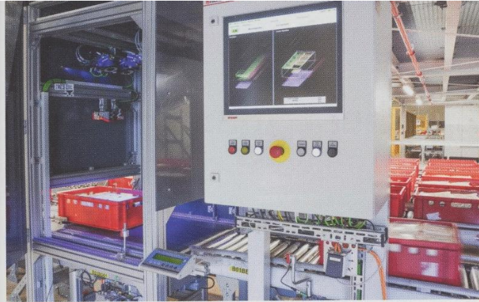
Ein vollautomatisches Vermessungssystem prüft E2-Kisten auf Förderfähigkeit.
