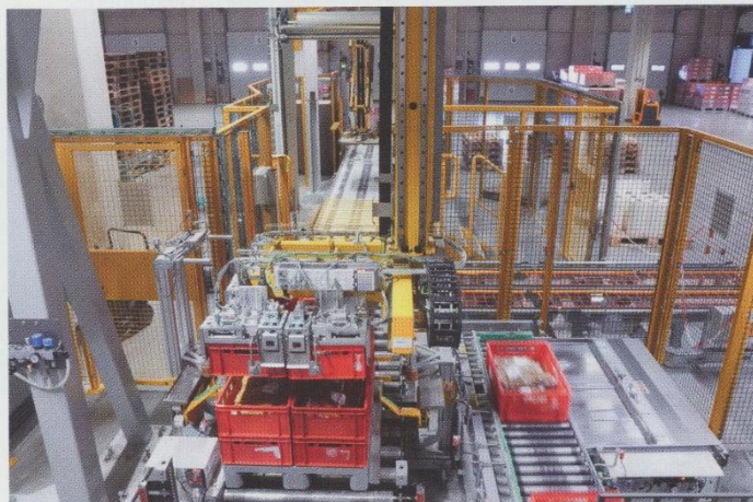
Dieser automatische Palettierroboter stapelt Euro-Fleischbehälter lagenweise.
