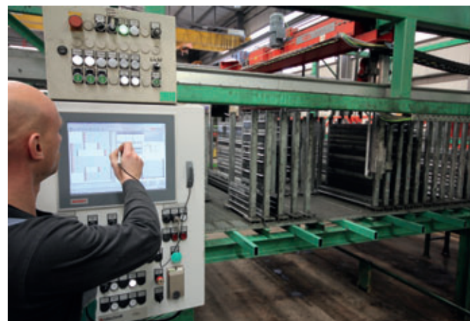
Neue Robotersteuerung verwaltet auch das Schalungsmagazin
