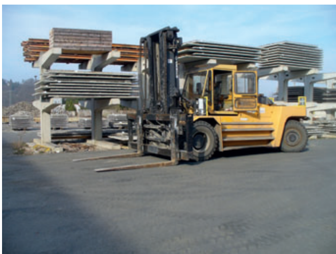
Außenlager mit Kragarmregalen
