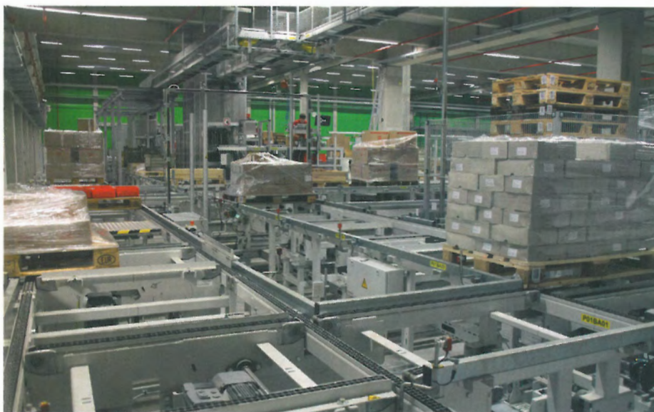
Die Palettenfördertechnik verbindet den Wareneingang mit dem HRL und der Kommissionierung.
