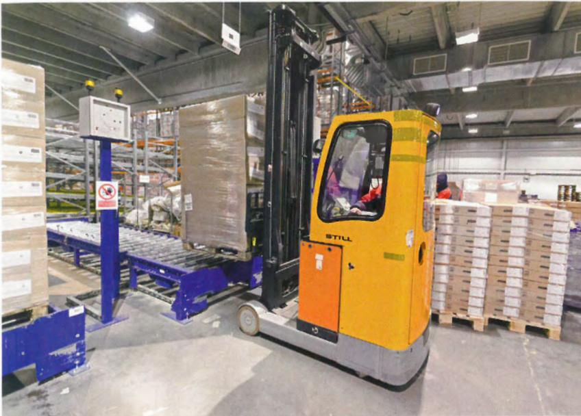
Elektrostapler bringen die angelieferten Paletten zur Fördertechnik. Sensoren überprüfen dort, ob sie zur Einlagerung in das Hochregallager geeignet sind.
